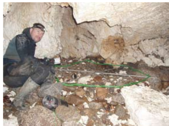
Rilevamento Georadar interno-esterno, nel punto terminale ramo sud del Bue Marino e la codula di Luna (foto J. Zilina - Česká Speleologická Společnost)
