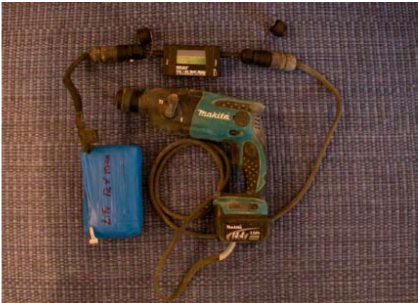
trapano, meccanismo di controllo della tensione (multimetro), batteria LiFePO
